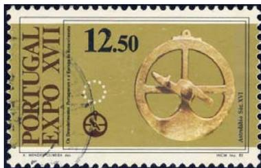
En la navegación se utilizaba para observación y toma de alturas, lo que permitía, a través de observaciones del sol de día y de las estrellas de noche, obtener una de las coordenadas posicionales: la latitud; el procedimiento para obtener la longitud no sería resuelto hasta el siglo XVIII.
