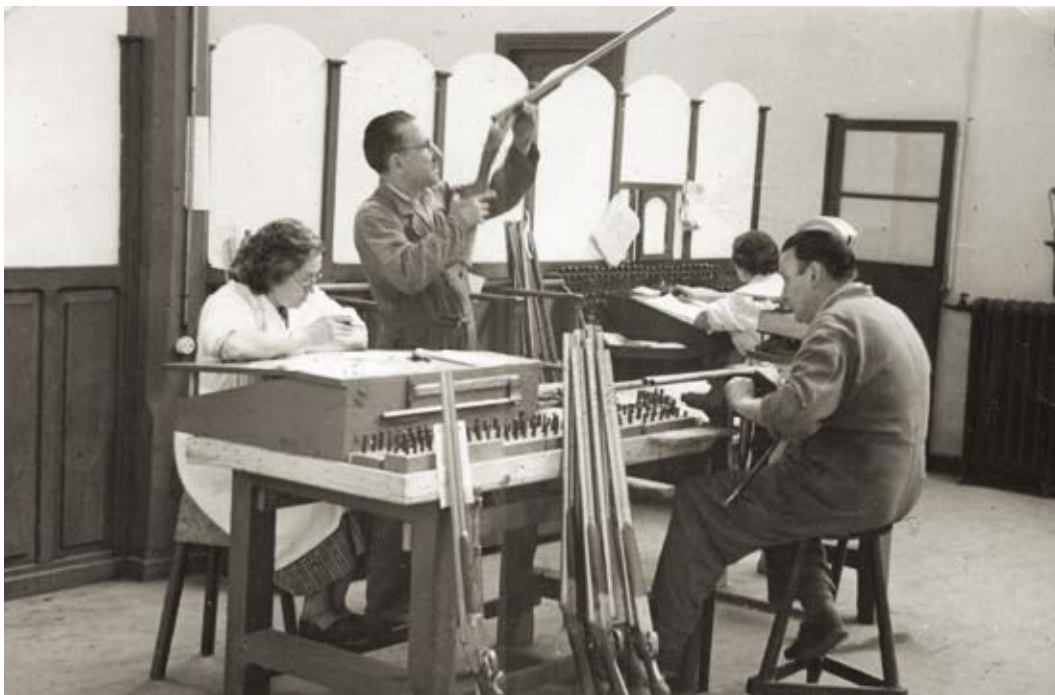
Trabajando en la sala grande del Banco de Pruebas, año 1957. Avelina Acha, que dedicó la mayor parte de su vida profesional al Banco de Pruebas, apunta los datos del arma (número, medidas y peso) que le va diciendo -"cantando" en su argot- Francisco Lasuen después de reconocer la escopeta. Al otro lado de la mesa Bernardo Echaniz punzona los datos en el arma. Al fondo, Carmen Echaluze dando entrada al arma en el registro. Colección Estibaliz González.
