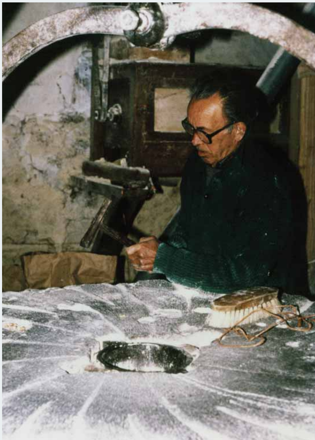
El molinero Ignacio Antia Goiburu picando la piedra “goiko arria” en su molino de Oria errota en 1981. Foto: Koldo Lizarralde.
