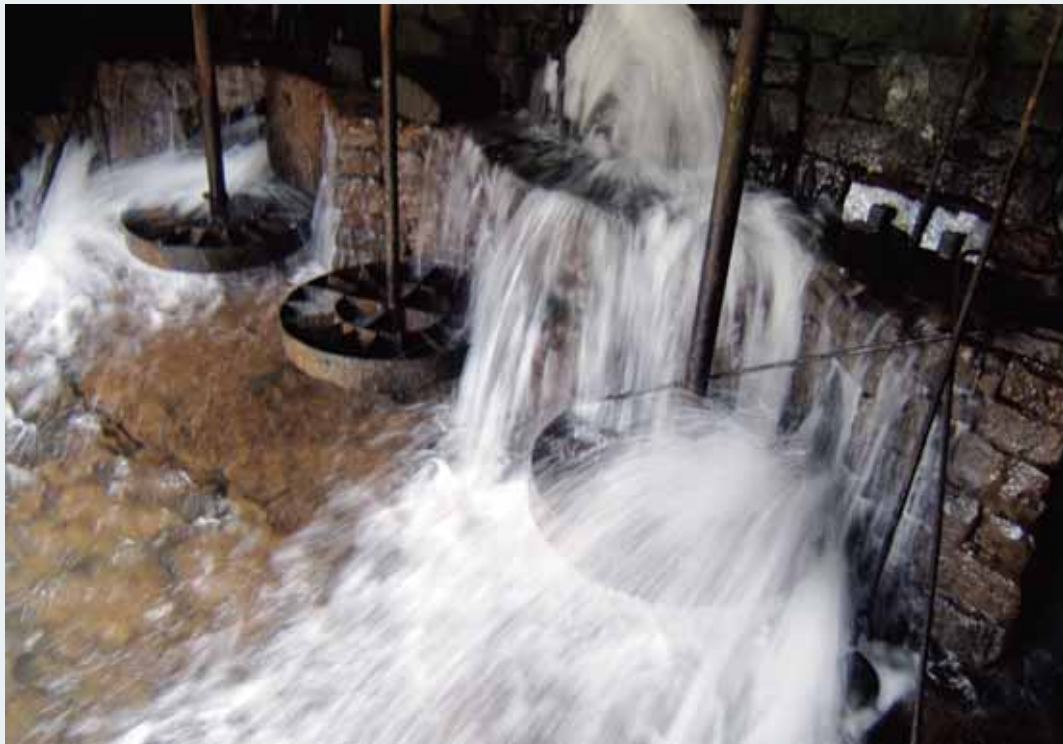
Rodetes “azen-naizia” de un molino en pleno funcionamiento. Foto: Koldo Lizarralde.
