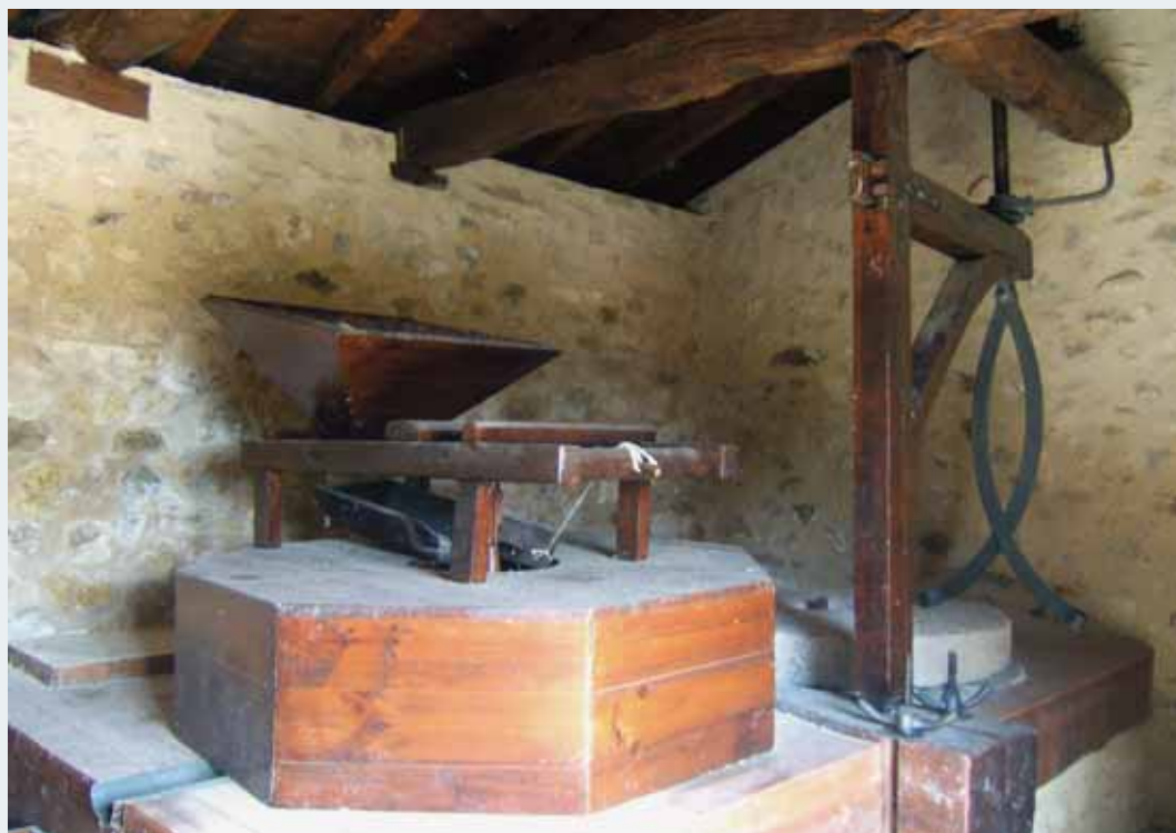
Pescante, instrumento especial para dar la vuelta a la piedra volandera y de ese modo poder picarla o cambiarla. Foto: Koldo Lizarralde.
