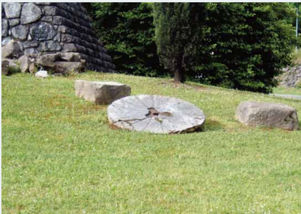
Piedra de molino en la que se aprecian los rayones “arri kanala” necesarios para que se produzca la molienda del cereal. Foto: Koldo Lizarralde.
