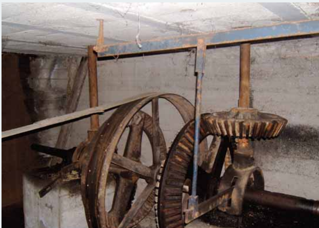
Acoplamientos que se realizaban en los molinos para poder mover otros instrumentos, como alternadores, sierras y demás. Foto: Koldo Lizarralde.
