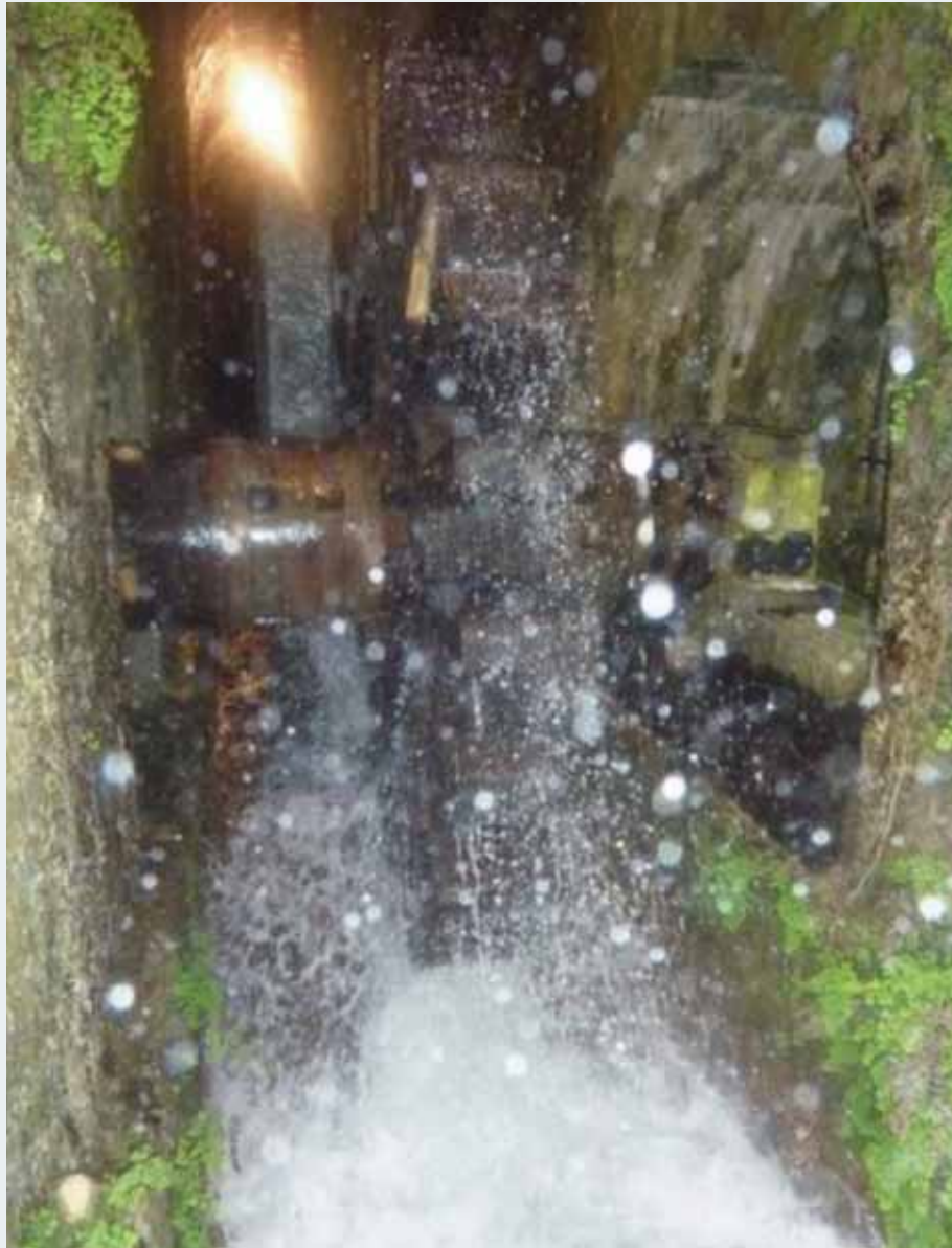
Rueda del uso mayor que da movimiento al mazo en la ferrería de Agorrei en Aia (Gipuzkoa).
