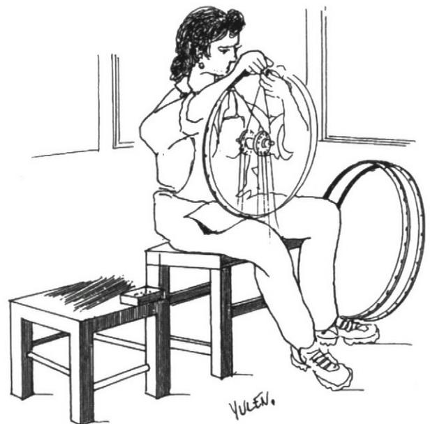
Hasta mediados los años cuarenta del siglo XX, las trabajadoras, sentadas, sujetaban la llanta entre o sobre sus rodillas y utilizando las dos manos, iban introduciendo los radios (por su parte roscada) en la cabecilla, previamente colocada en los orificios de aquella, sujetandolas mediante un pequeño roscado. Esta pieza era una especie de tornillo agujereado y roscado internamente en toda su longitud, ranurado en su parte superior y de forma cuadrada en el otro extremo.
