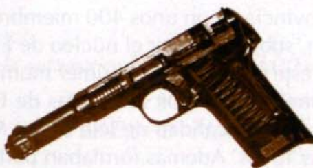
Pistola Astra de 9 mm. modelo 1.921 reglamentaria para el Ejército Marina y Cuerpo de Carabineros en 1930. Este ejemplar está seccionado para instrucción. Museo del Ejército. Madrid y Toledo.
