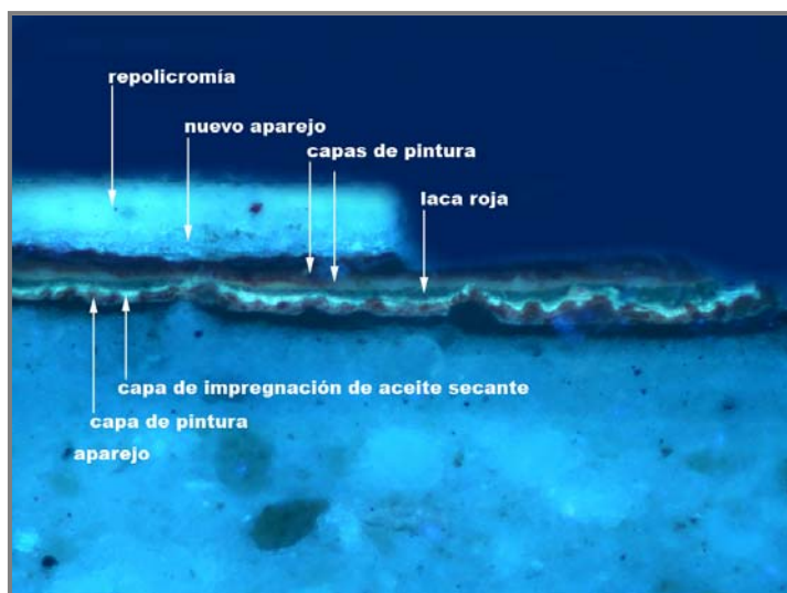
Figura 6 b.- Imagen obtenida al microscopio óptico de la sección transversal de la micromuestra N° 6 (objetivo MPlan 10 X / 0,25). Observación con luz UV, se puede ver la fluorescencia característica de la capa de impregnación de aceite secante
