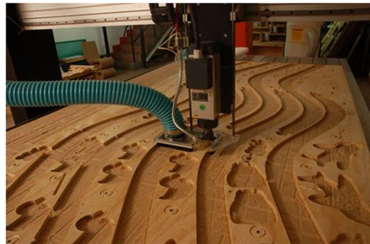
Mueble realizado mediante fabricación digital. Corte de una plantilla mediante cortadora digital.
